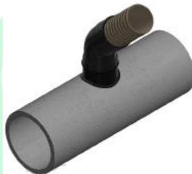
Figura 11. Conexión a tubería de concreto
