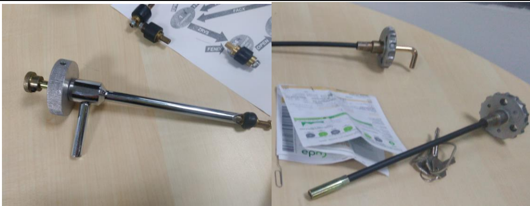
Esquema 3. Pistola mecánica y Guaya para introducción de dispositivo expansible (Foto: Propiedad de EPM)
