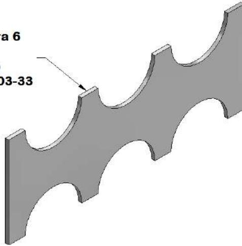
**Separador para 4 ductos de 4" (114.30mm)**
