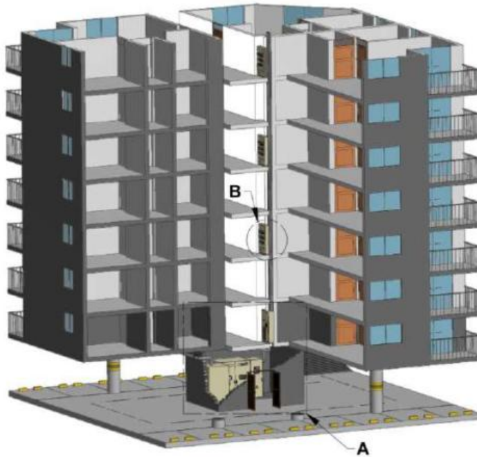
Figura 3. Sistema de medida distribuida con tableros ubicados en diferentes niveles de la edificación.
