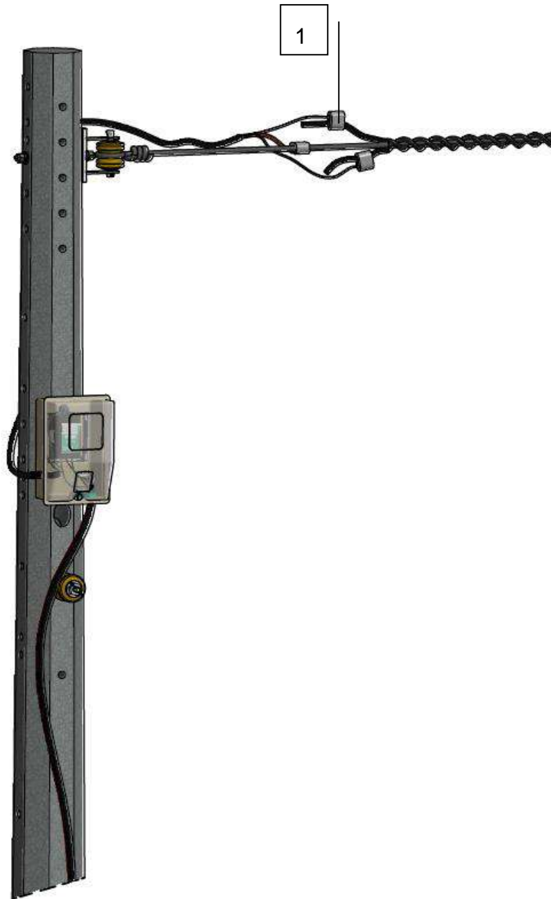
Figura 9. Instalación de un medidor bicuerpo
