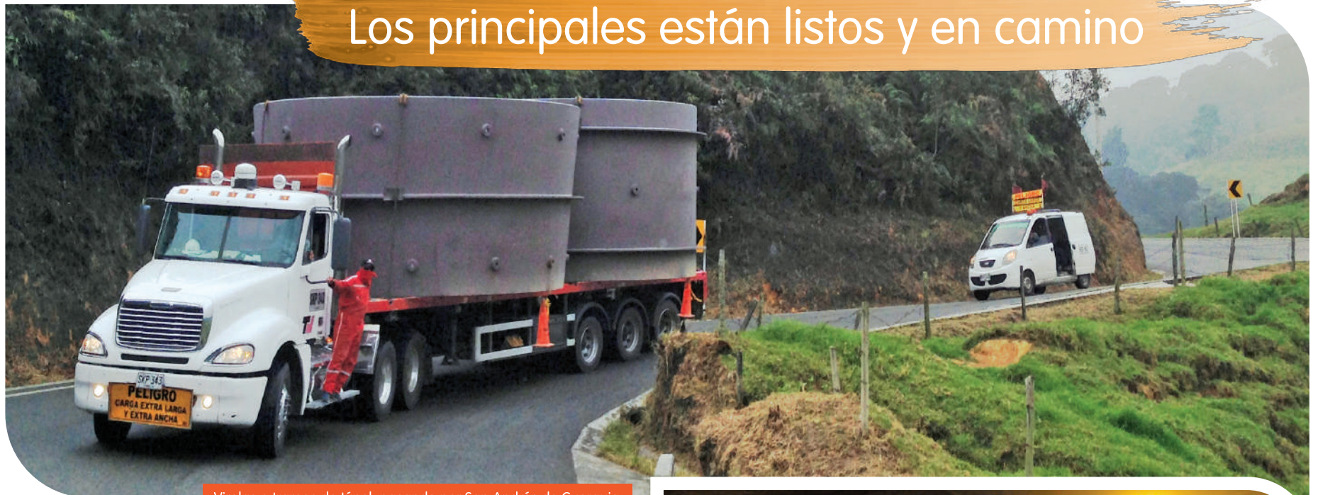
Virolas o tramos de túnel, pasando por San Andrés de Cuerquia.
